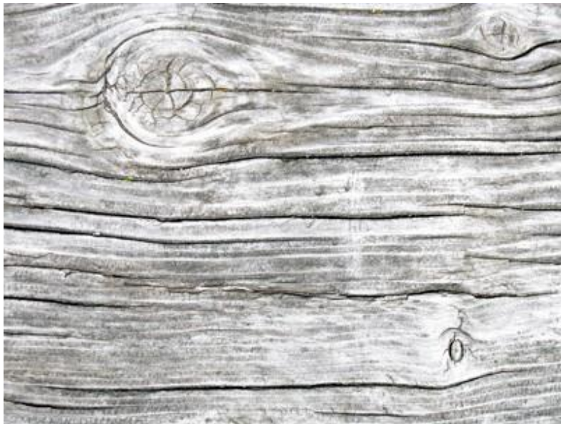
Fot. 12. Drewno wybarwione poprzez działanie promieni nadfioletowych zawartych w świetle słonecznym.
