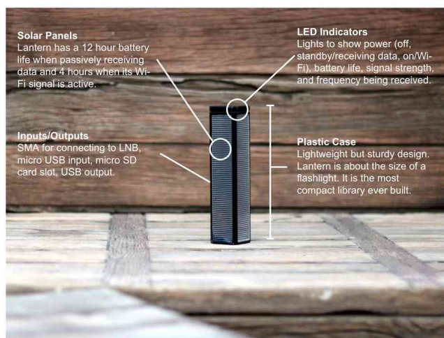
Fot. 2.15. Mikroserwer Lattern - niezależny energetycznie oraz informacyjne serwer danych
