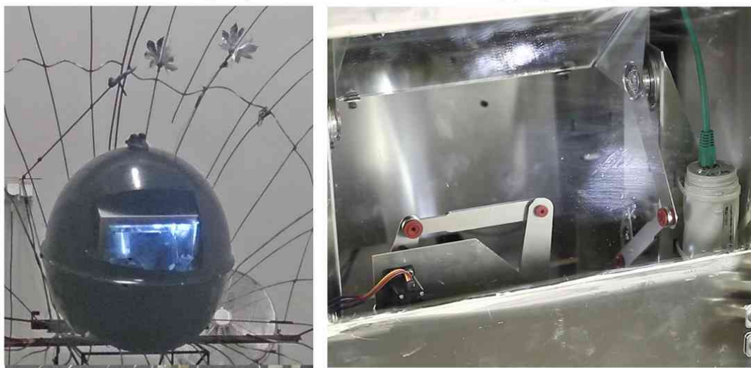
Fot. 4.9. Obudowa perły oraz detale układu sterującego snopem światła
